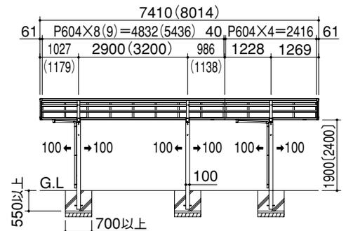
土間コンクリート施工の場合の基礎寸法
